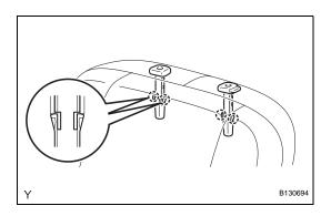
(d) Disengage the 2 claws and remove the front seat headrest support.
